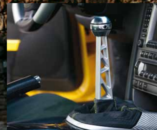
Zug- und Druckstufe einmal anders interpretiert: Ein sequenzielles Sechsgang-Getriebe dient dem Übersetzungswechsel, kuppeln muss der Fahrer noch per pedes
